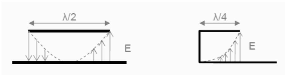
Obr. 2.5: Rozložení elektrického pole mezi patchem a zemní rovinou.
